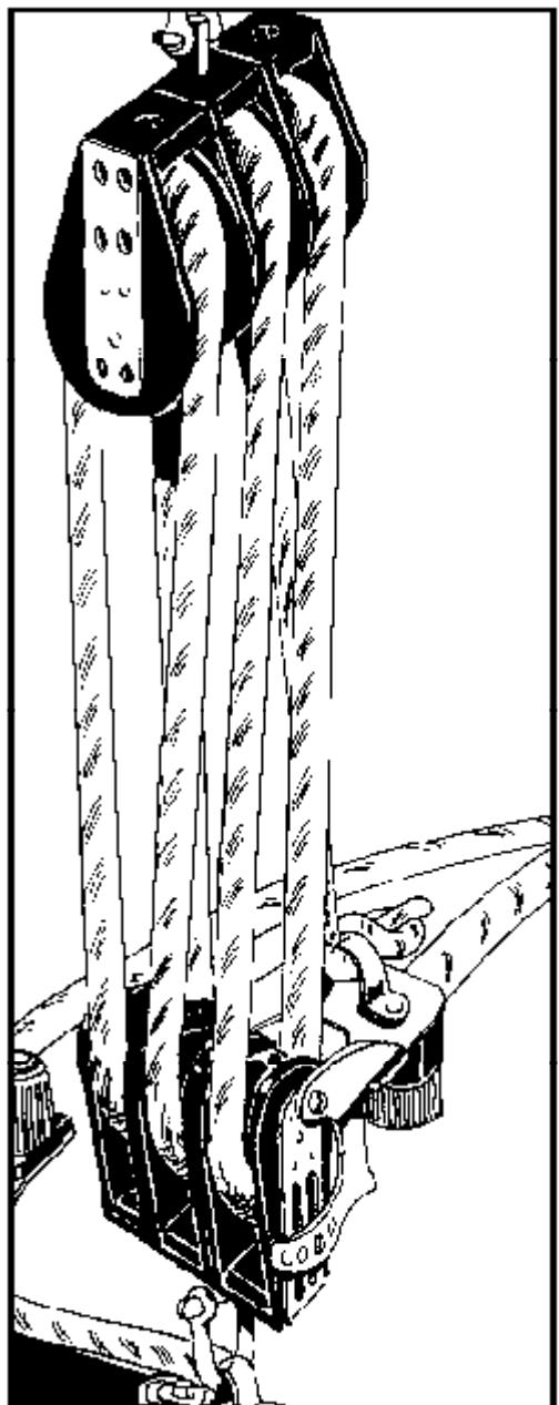
*Prendre la poulie triple bôme et la fixer au collier de bôme par sa manille, puis la poulie triple winch pour l'accrocher au pontet du chariot CCT par sa manille (taquet coincer dirigé vers l'intérieur du bateau)*
