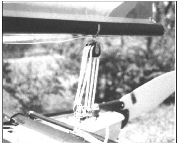
Jetzt gehen Sie durch die Großschotklemme des Knarrblocks. Die Blöcke sind um 90 ° verdreht zueinander. Gehen Sie mit dem Ende der Schot durch die Schotklemme und die Doppelrolle auf dem Achterholm, von vorne nach hinten durch die weiße Doppelrolle des Travellers. Schließlich von oben nach unten durch den Bügel in der Mitte des Achterholms. Machen Sie einen Achtknoten in das Ende der Schot.
