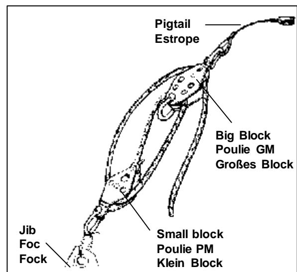
Nehmen Sie die zwei Blöcke für das Fockfall und das Fockfall. Machen Sie den großen Block mit einem Schäkel am Pigtail fest. Befestigen Sie das Fall mit einem Palstek am kleinen Block. Führen Sie das Fall über die untere Rolle des großen Blockes zur Rolle des kleinen Blockes und über die obere Rolle des großen Blockes (siehe Abbildung).
