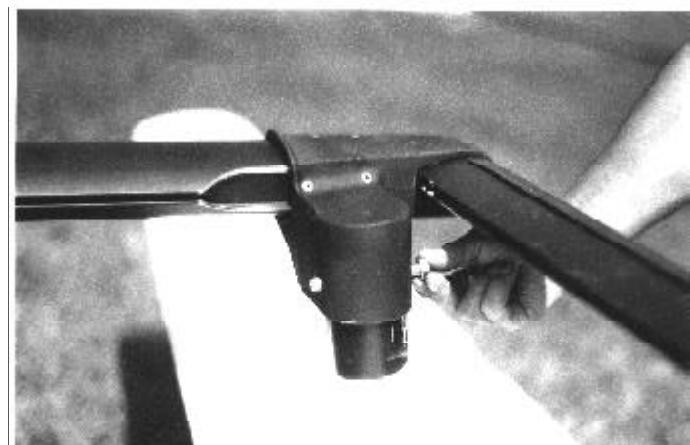
Fügen Sie die vier Pylonschrauben von außen nach innen ein. Ziehen Sie die Muttern mit einem 17er-Schlüssel gut fest, aber nicht zu stark.
